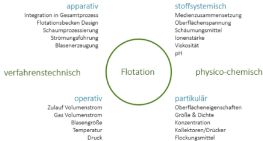
Abbildung 20: Einflussfaktoren Flotation (Johan Gulden, 2018)
