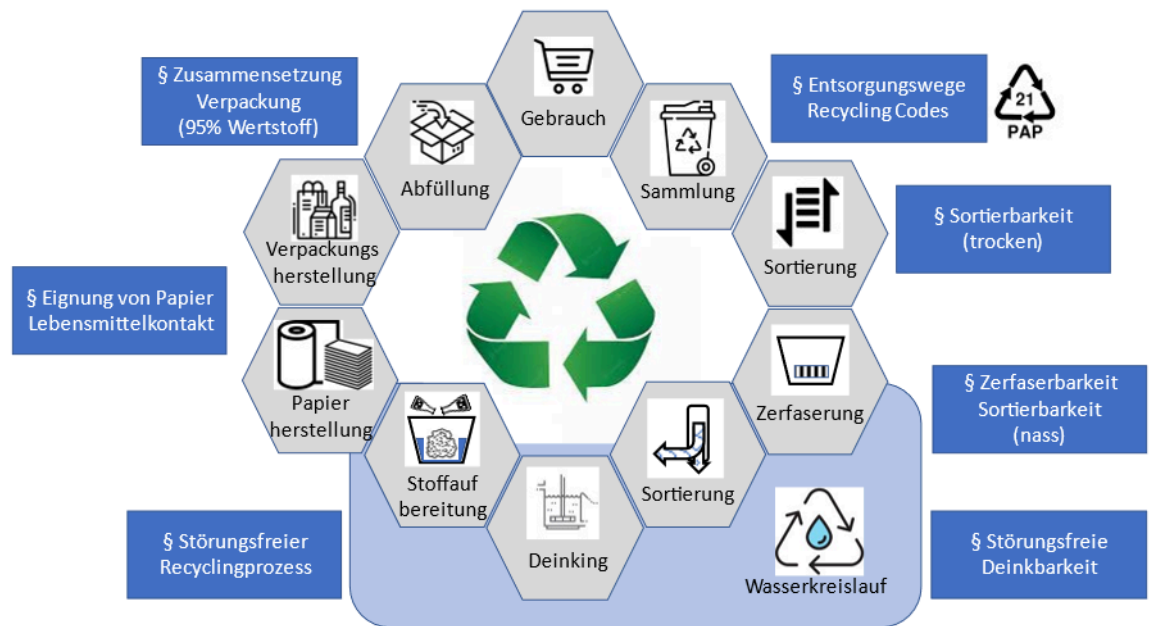
Abbildung 24: Übersicht über die Bewertungskriterien für die Recyclingfähigkeit im Materialkreislauf von faserbasierten Verpackungen
